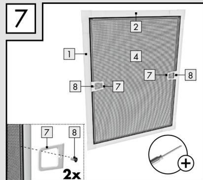
Schrauben Sie die Griffe **7** links und rechts mittels Schrauben **8** in die Schraubnut des Rahmenprofils **1**.
