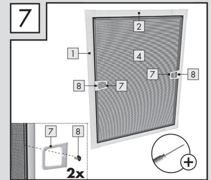
Schrauben Sie die Griffe **7** links und rechts mittels Schrauben **8** in die Schraubnut des Rahmenprofils **1**.
