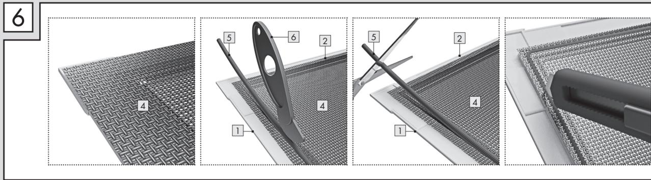
Rollen Sie das Gewebe **4** über dem Rahmen aus. Fixieren Sie das Gewebe **4** mittels Gummikeder **5** in der Kedernut der Profile **1** und **2** und spannen Sie das Gewebe nicht zusätzlich, um zu vermeiden, dass der Rahmen sich verzieht. Verwenden Sie dazu das Kederwerkzeug **6**. Kürzen Sie den Keder **5**, nachdem Sie diesen umlaufend befestigt haben, mit einer Schere. Kürzen Sie das Gewebe **4** außen entlang des Keders **5** mit einem Cutter.
