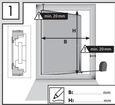
Messen Sie die lichte Breite Maß B, indem Sie den horizontalen Innenabstand des geöffneten Fensters messen. Messen Sie die lichte Höhe H, indem Sie den vertikalen Innenabstand des geöffneten Fensters messen.
