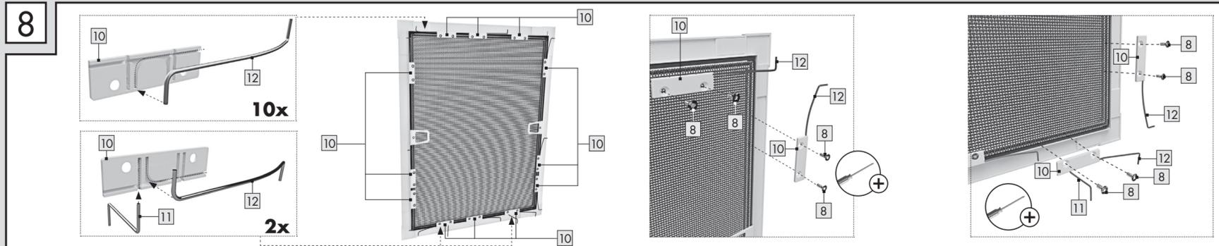
Bringen Sie die Befestigungsfedern **12** am Rahmen an. Stecken Sie dazu je eine Befestigungsfeder **12** wie abgebildet in den Befestigungsclip **10**. Die Befestigungsfedern in den Randbereichen zeigen mit der Spitze nach außen. Die beiden Auflagefedern **11** werden in den beiden unteren, äußeren Befestigungsclips **10** angebracht. Schrauben Sie die Befestigungsclips **10** samt Befestigungsfedern **11** und **12** mittels Schrauben **8** in die Schraubnut des Rahmens.
