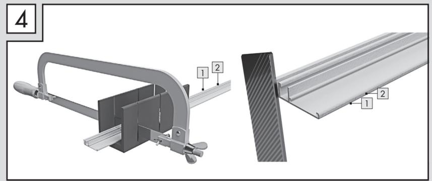
Kürzen Sie die Profile **1** und **2** an den markierten Stellen mit einer Metallsäge und entgraten Sie die Schnittstellen mit einer Feile.
