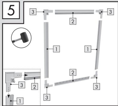
Verbinden Sie die Profile **1** und **2** mittels Eckverbinder **3** zu einem Rahmen. Verwenden Sie dazu vorsichtig einen Gummihammer.
