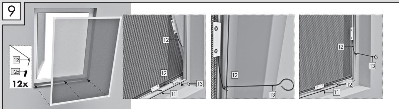
Stecken Sie die Schutzkappen **12a** auf die Befestigungsfedern **12**. Führen Sie den Insektenschutz an das Fenster und stellen Sie diesen auf den beiden Auflagefedern **11** in die Fensterlichte. Ziehen Sie sämtliche Befestigungsfedern **12** mittels beiliegendem Werkzeug **13** nach innen, sodass die Federn hinter den Blendrahmen greifen. Drehen Sie die Auflagefedern **11** an den Fensterstock.
