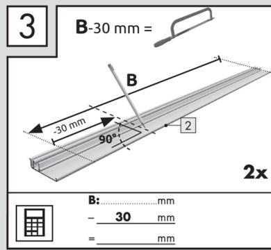
Markieren Sie an den Profilen **2** das Maß B abzüglich 30 mm.
