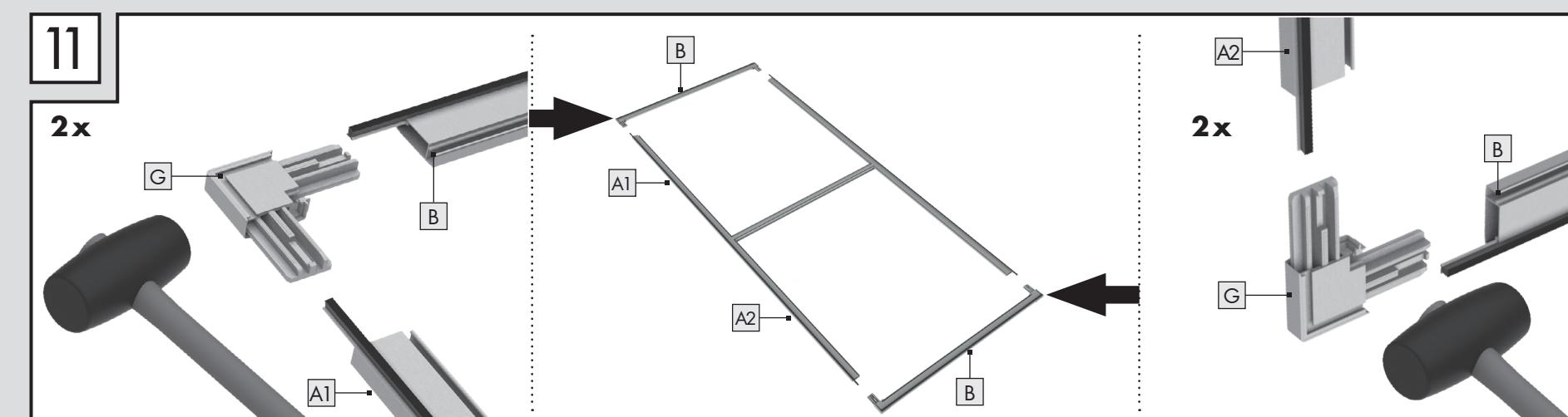
**DE** Verbinden Sie das obere Querprofil **B** mittels der Eckverbinder **G** mit den oberen Höhenprofilen **A1**. Verbinden Sie das untere Querprofil **B** mittels der Eckverbinder **G** mit den unteren Höhenprofilen **A2**.
