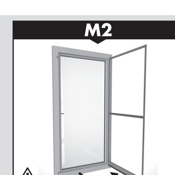
**DE** Positionieren Sie die Scharnierteile **N** jeweils 150 mm von der oberen und unteren Ecke nach innen und 100 mm von der Mittelsprosse nach oben.
